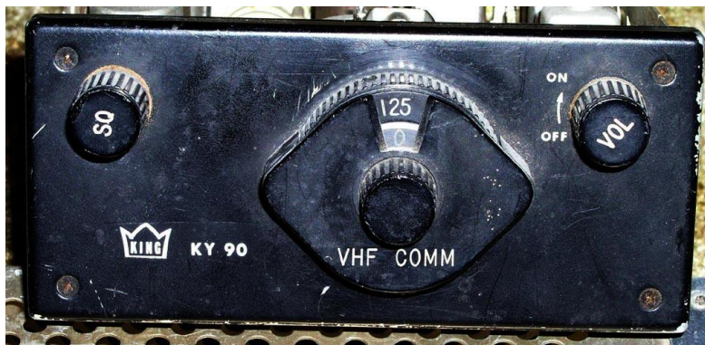
Figura 28. KY90 primer transceptor VHF fabricado por King Radio.
