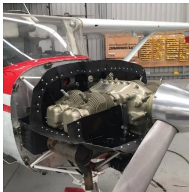
Figura 4. Motor O-200-A montado en una Cessna 150
