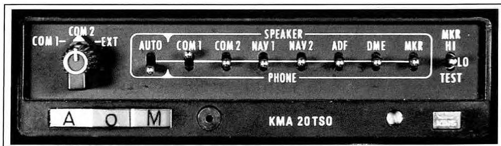
Figura 18. Panel antiguo de control de audio.
