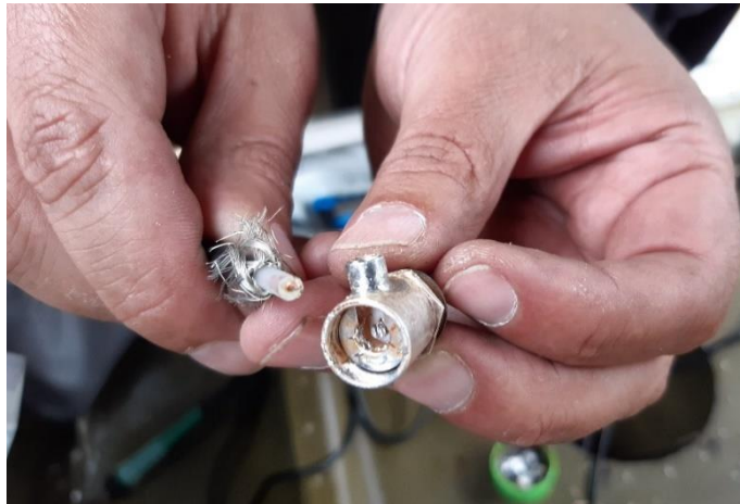
Figura 37. Soldadura entre el cable coaxial y el conector MB
