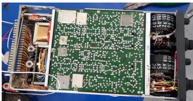
Figura 33. Inspección y limpieza interna del radio.
