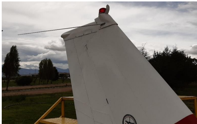
Figura 38. Antena VOR instalada en el estabilizador vertical.
