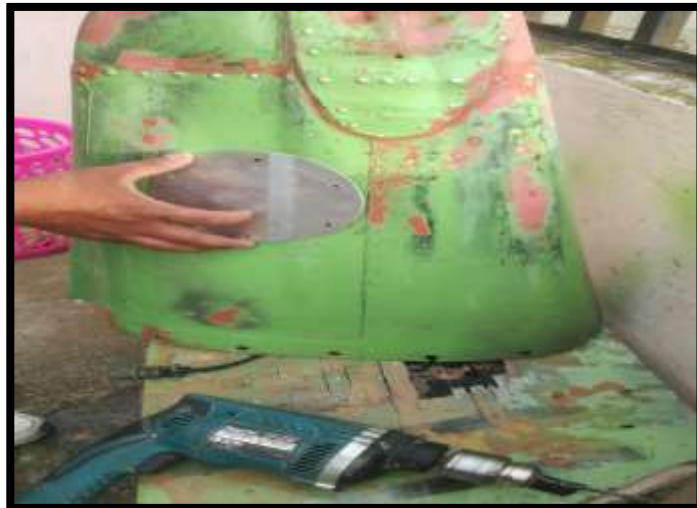
Figura 35. Fabricación de las tapas de inspección
