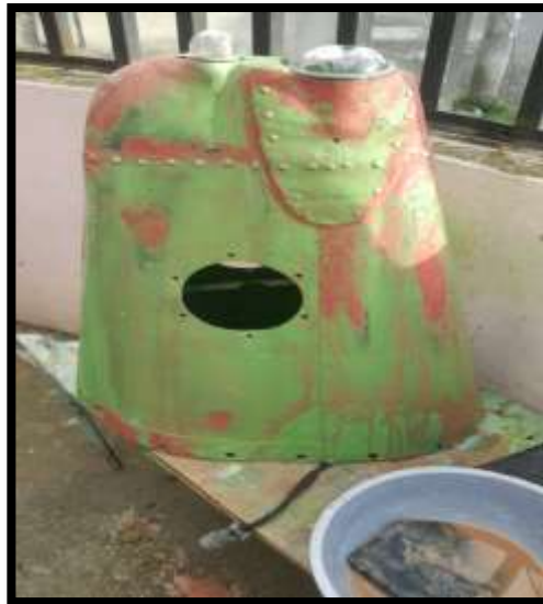
Figura 28. Limpieza del cono de cola
