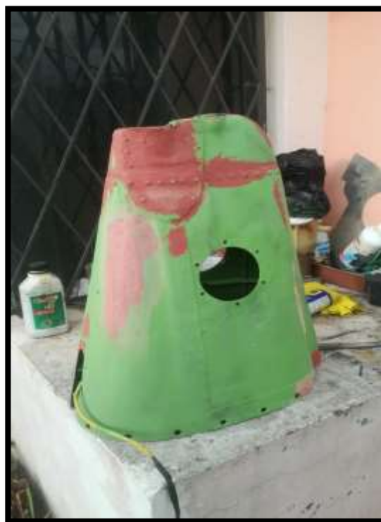
Figura 30. Reparación del cono con resina
