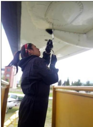
*Figura 36.* Tapas de inspección
