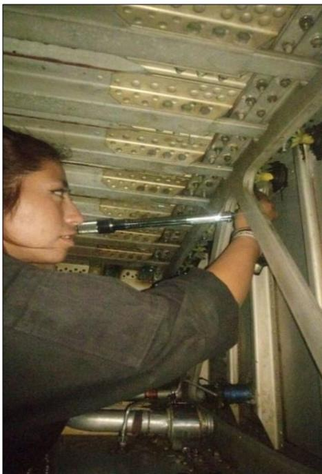
*Figura 66.* Aplicación de torque a los montantes
