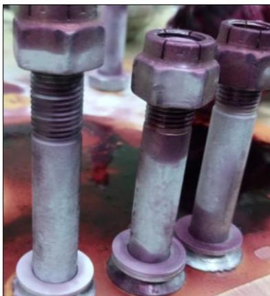
*Figura 61.* Montantes cubiertos de revelador
