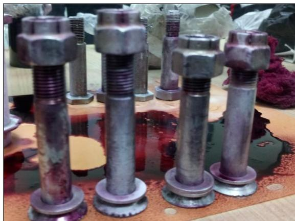
*Figura 60.* Limpieza de exceso de líquido penetrante
