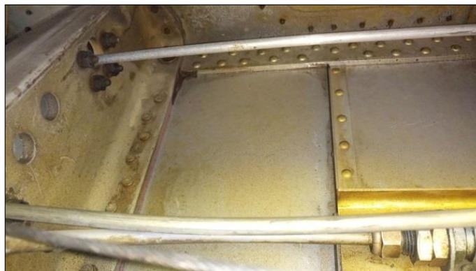
*Figura 34.* Estructura de tanques externos
