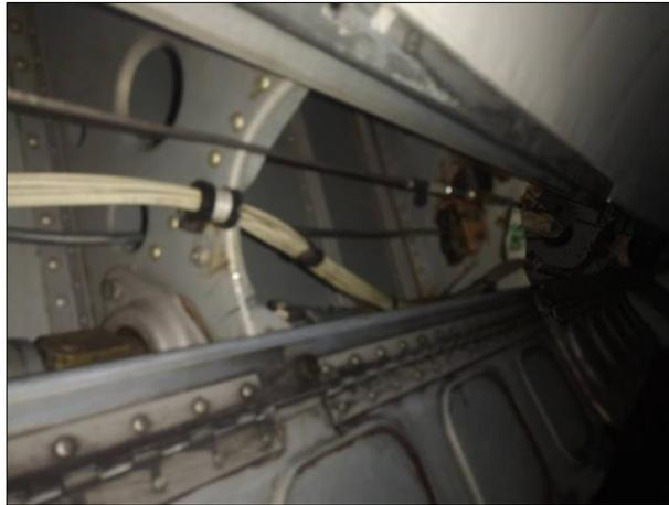
*Figura 69.* Cables del alerón derecho
