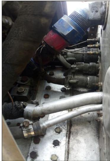
*Figura 44.* Desconexión de cañerías y cables
