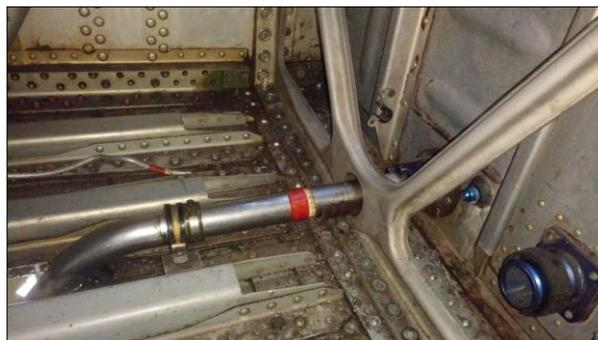
*Figura 48.* Desconexión de líneas de combustible
