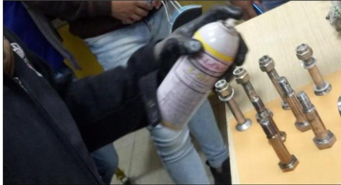
*Figura 59.* Aplicación de líquido penetrante
