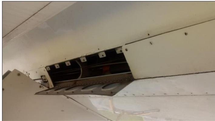
**Figura 33.** Tapas de acceso al borde de salida
