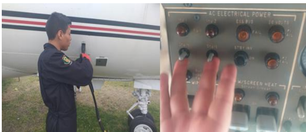
Figura 21. Energizado y encendido de la aeronave.
