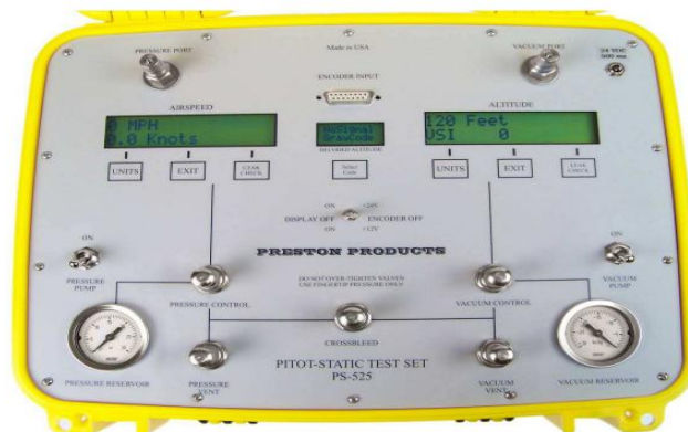
Figura 14. Pitot – static test set. Fuente: (prestonpressure.com).
