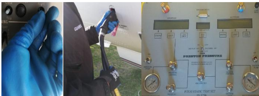
Figura 29. Desenergizado de la aeronave y apagado del equipo de pruebas. Fuente: Investigación de campo.
