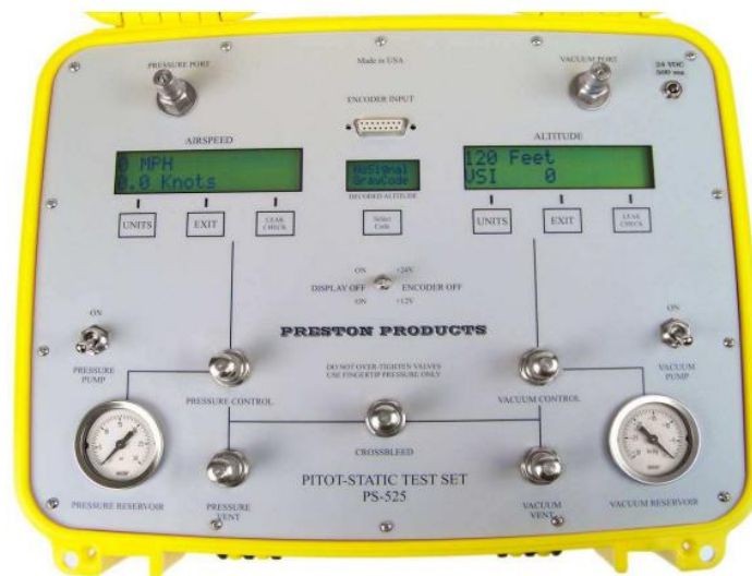
Figura 17. Pitot – static test set. Fuente: (prestonpressure.com).
