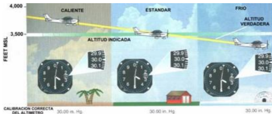
Figura 7. Operación del altímetro con relación a la temperatura. Fuente: (H, s.f.).
