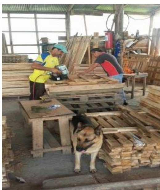
Figura 6: Área de armado de pallet's
