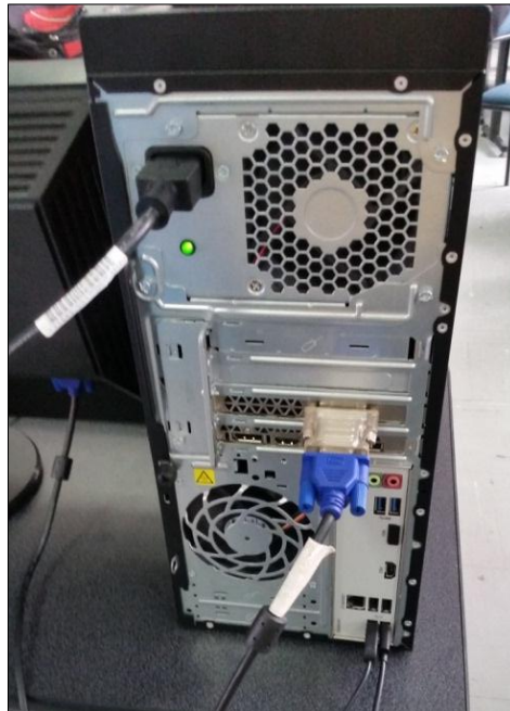
Figura 25 Conexión Externa del Equipo
