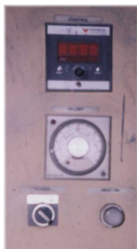
Fig. 2.8. Dispositivos de control de calentamiento.
