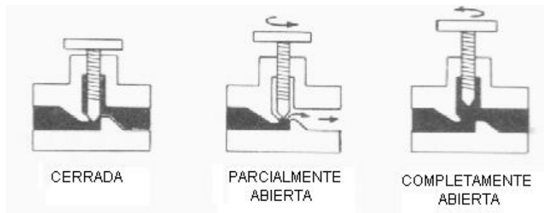
FIGURA 1.19 Válvula de Aguja no Compensada
