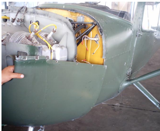
FIGURA A2. DESMONTAJE DE LA CUBIERTA DEL MOTOR
