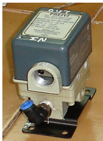
Figura. 3.7. Transductor de corriente a señal neumática.
