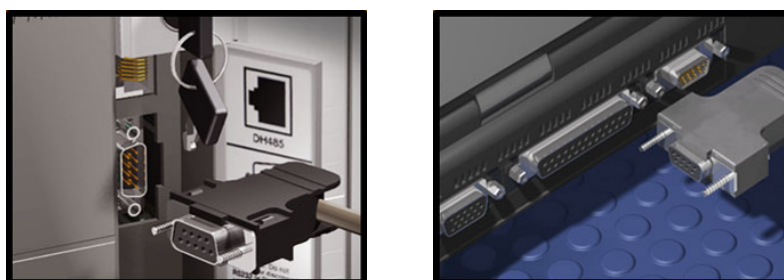
Figura. 4.9. Conexión serial PLC - Computador
