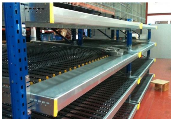
Figura 5 Estanterías Dinámicas Motorizadas.
