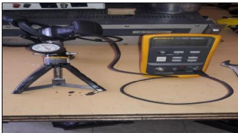
**Figura 39** Herramientas para la calibración del manómetro
