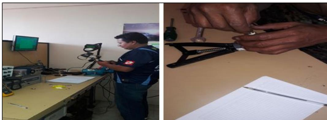
**Figura 40** Calibración de los manómetros
