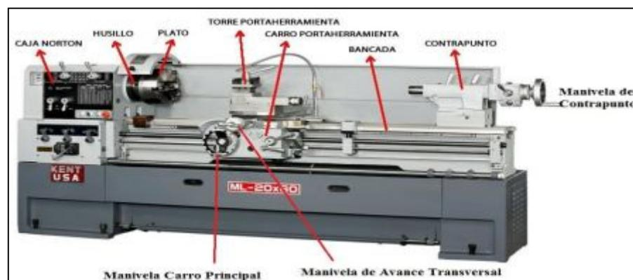
**Figura 17** Partes del torno
