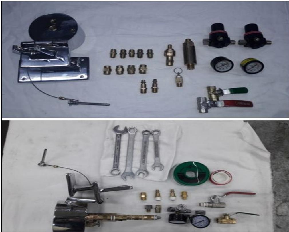
**Figura 42** Elementos para ensamblar el Banco de Prueba
