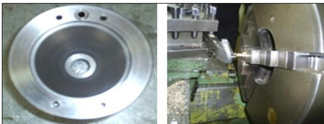
**Figura 32** Soporte de sujeción moldeado en el torno
