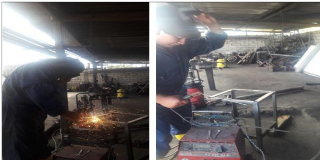
**Figura 36** Construcción de la mesa transportadora
