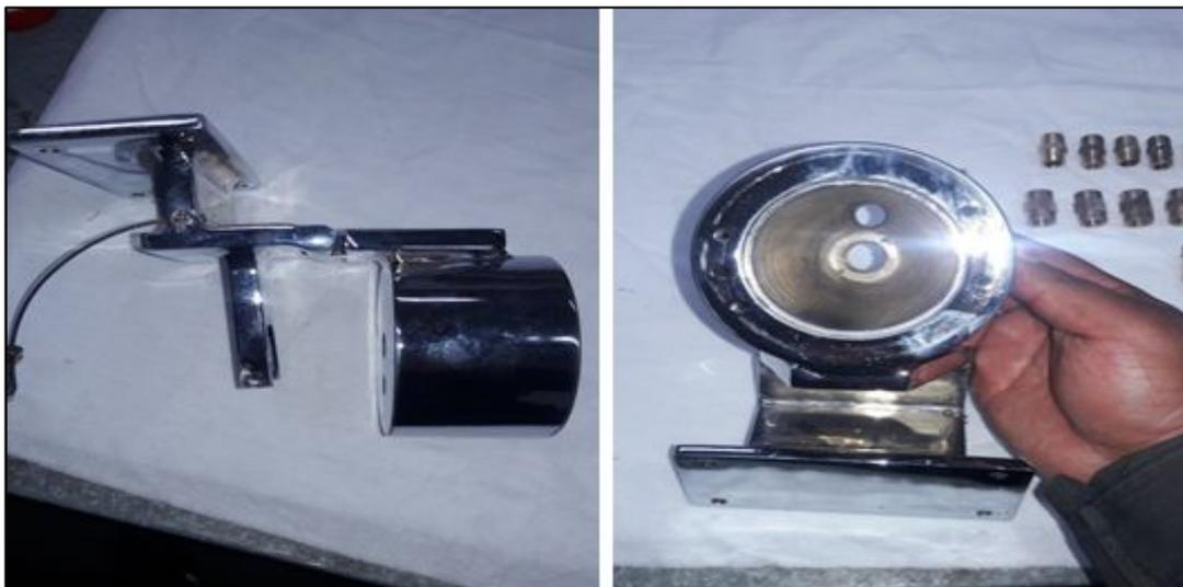
**Figura 35** Soporte de sujeción para la Bleed Valve
