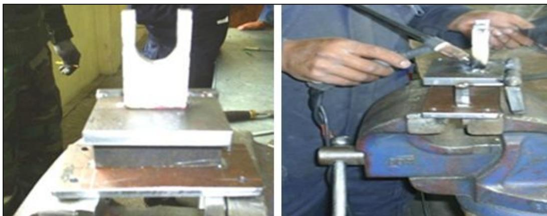
**Figura 34** Construcción de la base del soporte de sujeción
