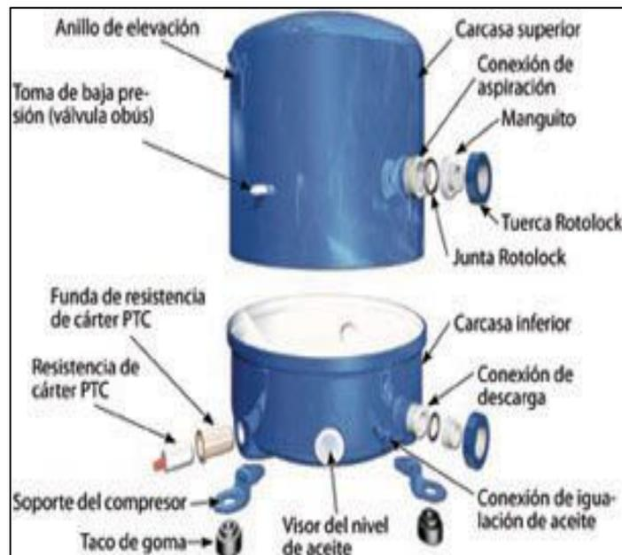
**Figura 29** Partes del compresor de aire
