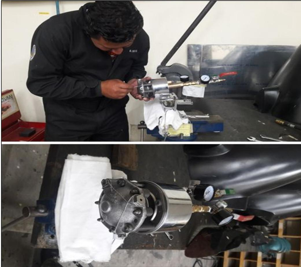
**Figura 46** Instalación de la Bleed Valve
