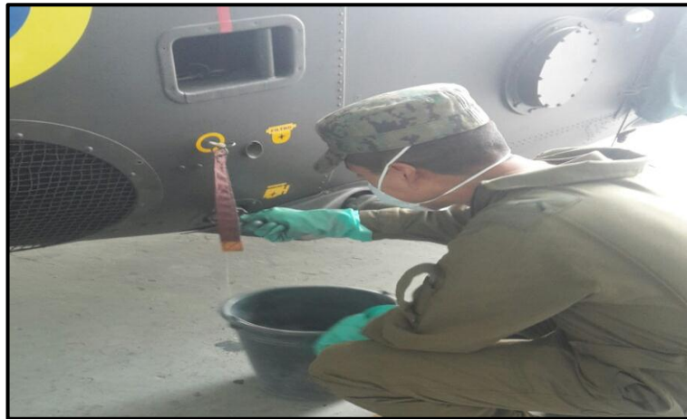
Figura 51. Drene del tanque de combustible
