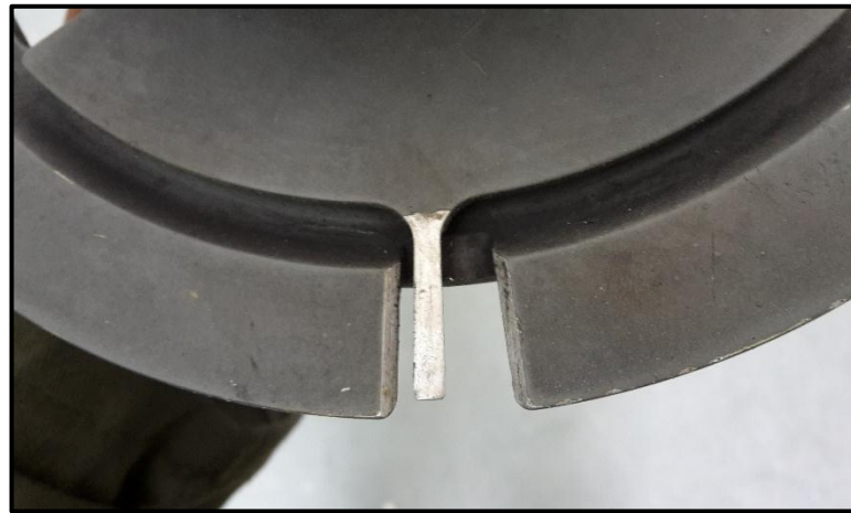
Figura 55. Árbol torquímetro en buen estado
