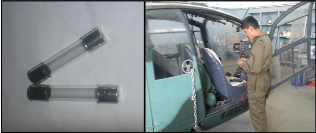
Figura 37. Chequeo de fusibles
