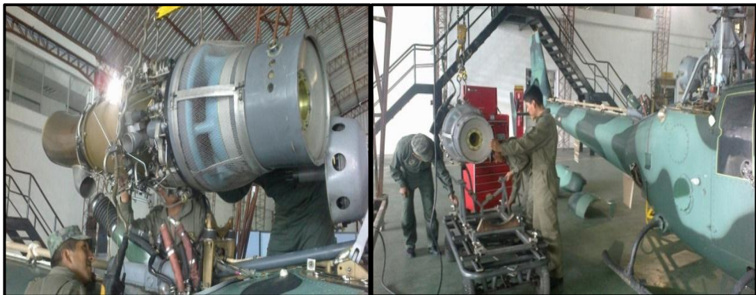
Figura 52. Desmontaje del motor
