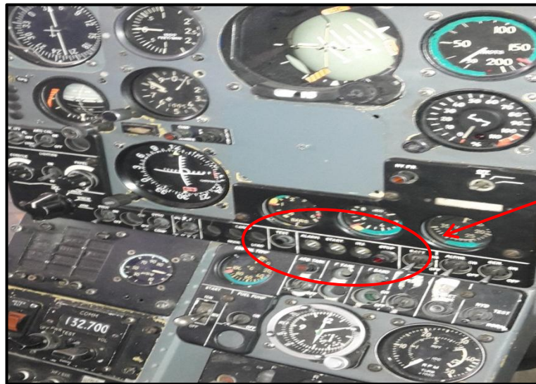
Figura 38. Luces de control
