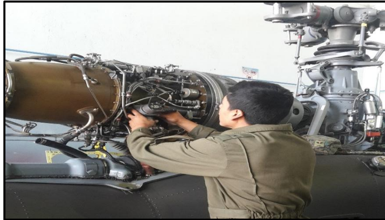
Figura 60. Desmontaje de la válvula de descarga
