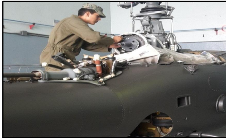
Figura 53. Desmontaje del árbol torquímetro
