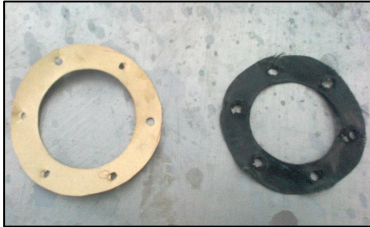
Figura 48. Junta de estanqueidad de la bomba Booster
