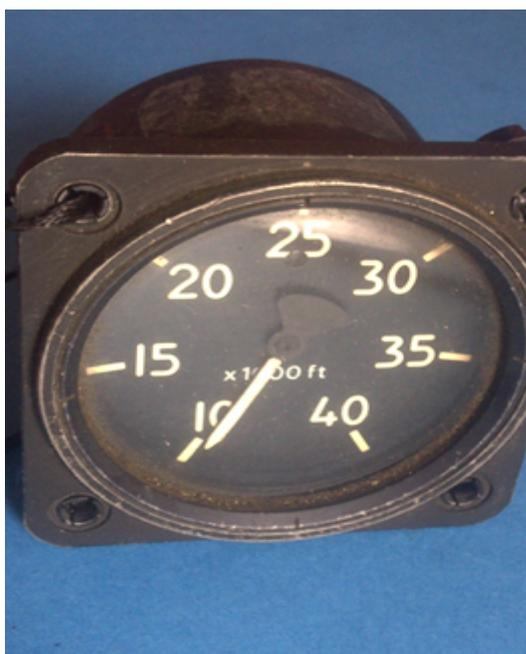
**Figura 9 El altímetro**
