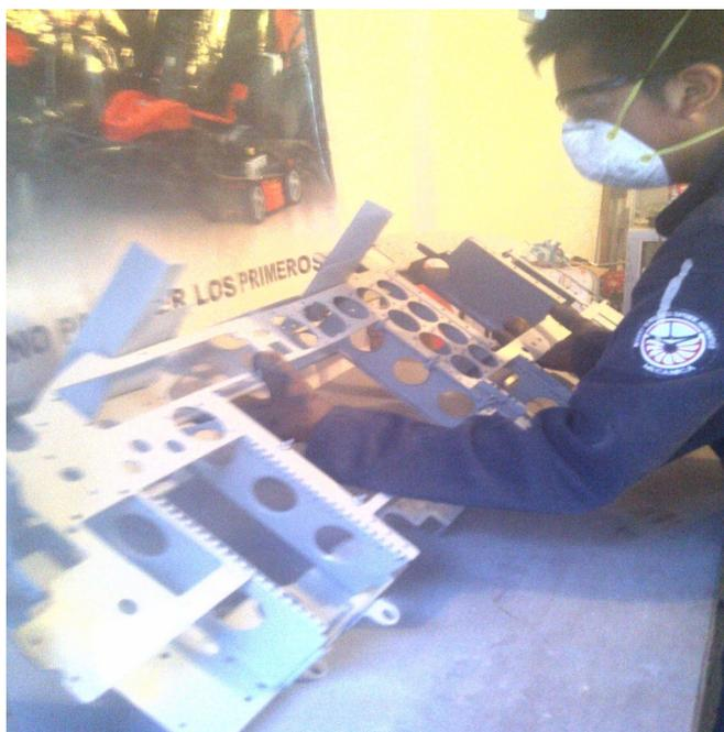
**Figura 39 Secado final para recibir tratamiento anticorrosivo.**
