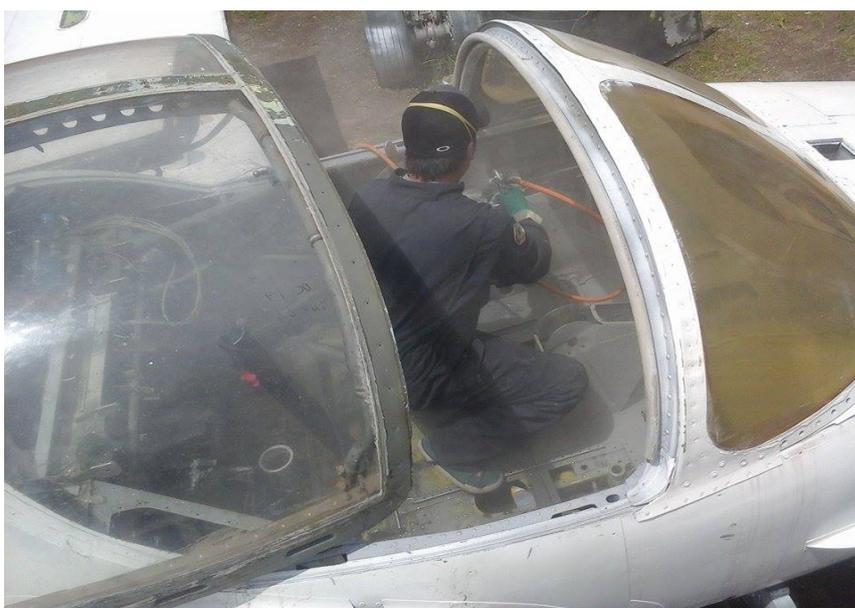
**Figura 44 Aplicación de tratamiento anticorrosivo en la cabina.**
