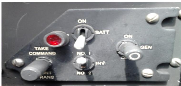
**Figura 6 Panel de control de arranque de motores**
