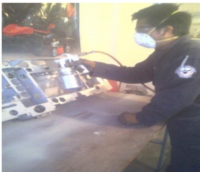
**Figura 43 Aplicación de tratamiento anticorrosivo**
