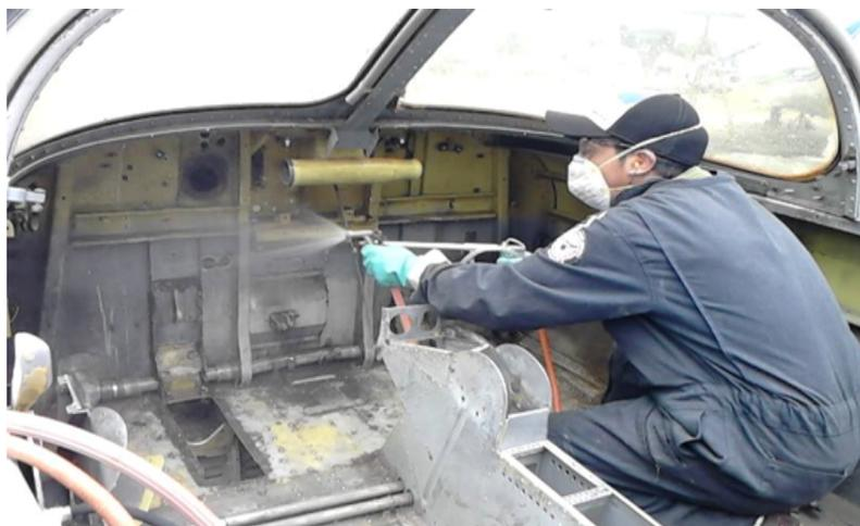
**Figura 34 Reparación y limpieza del interior de la cabina del avión.**
