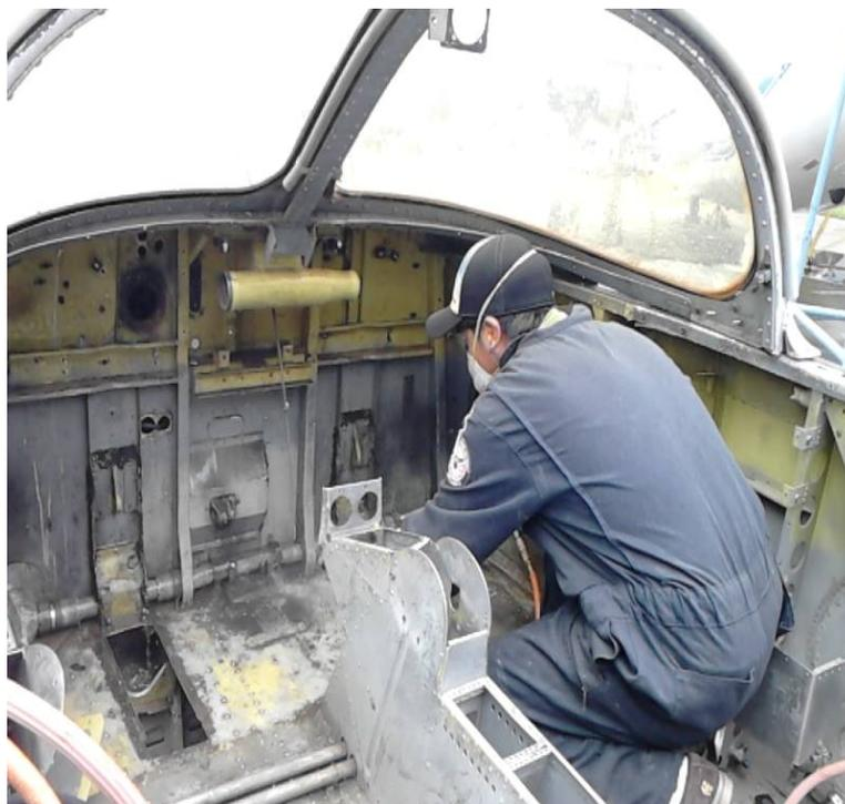
**Figura 28 Inspección visual de la cabina.**
