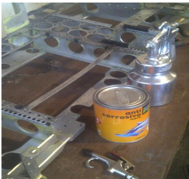
**Figura 42 Materiales para el tratamiento anticorrosivo.**
