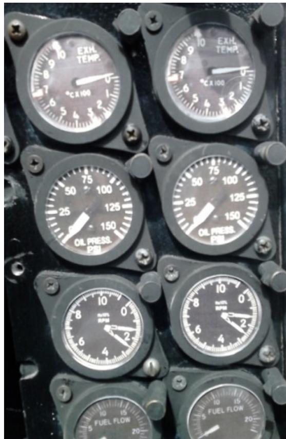
**Figura 5 Instrumentos moto propulsor.**
