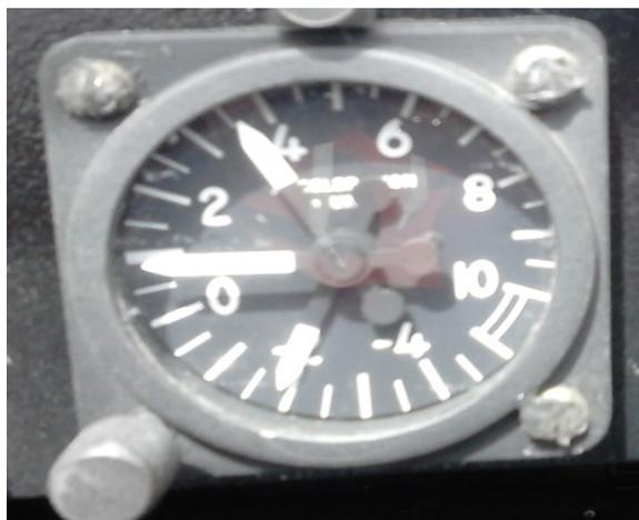
**Figura 11 Acelerómetro**
