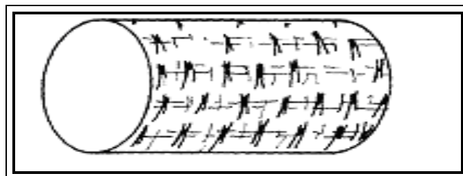
Figura 1.10b. Piques y arrancado de material
