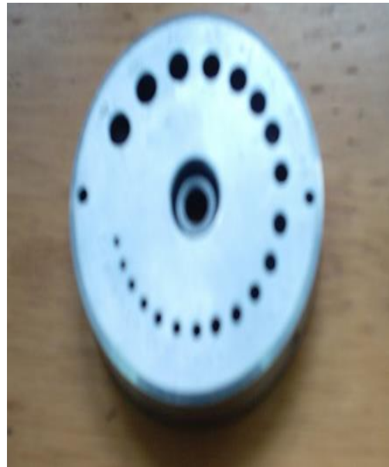
12.- orificios de 10 a 2.5mm. en la guía.
