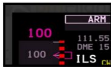
Figura 19 Indicador de velocidad seleccionada
