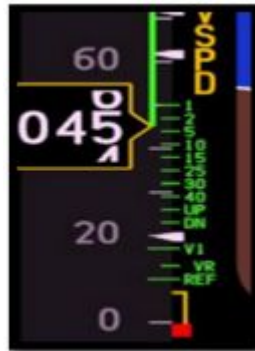
Figura 18 Referencia de velocidad FLAPS
