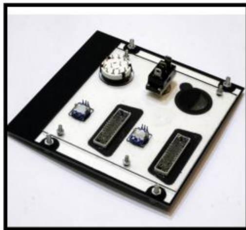
Figura 60 Acople de la electrónica de los paneles
