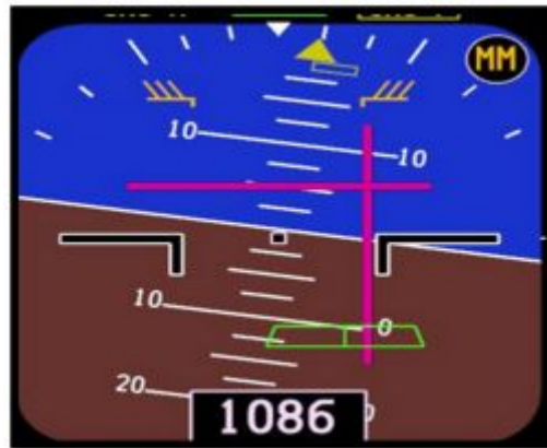
Figura 21 FMA Indicador de actitud de vuelo
