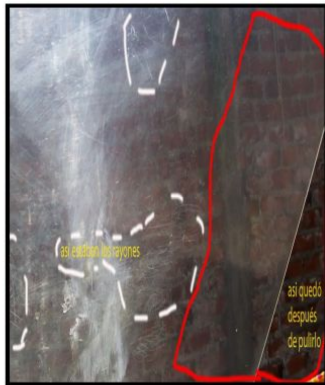
Figura 54 Perspectiva del acrílico sin pulido y con él pulido
