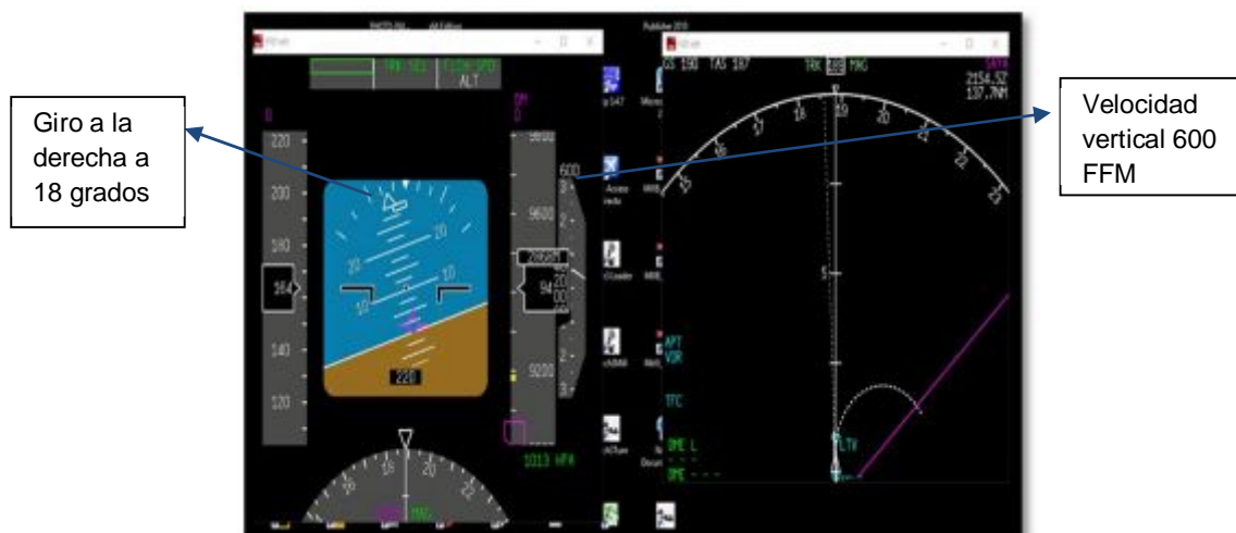
Figura 89 Indicaciones del coordinador de giro y su velocidad vertical
