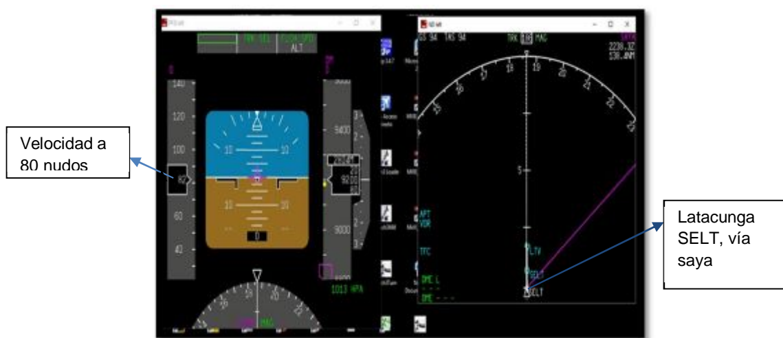
Figura 87 Indicaciones de velocidad y ubicación de la aeronave
