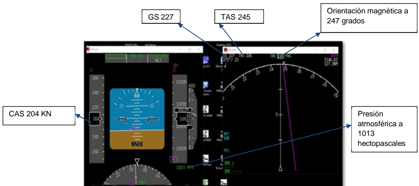
Figura 90 Indicaciones de la pantalla principal de vuelo
