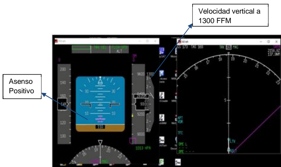
Figura 88 Indicaciones de asenso y velocidad vertical
