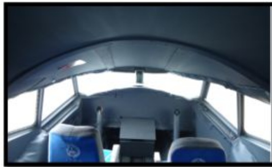
Figura 35 Cubierta temporal cabina del simulador.
