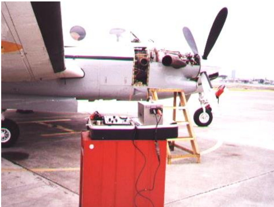
Fig. 4.5. Conexión del equipo al motor.
