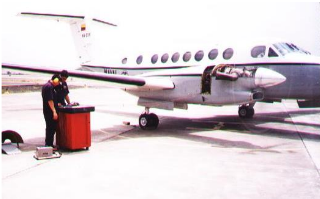
Fig. 4.6. Avión encendido con equipo Chadwick Helmunt conectado.
