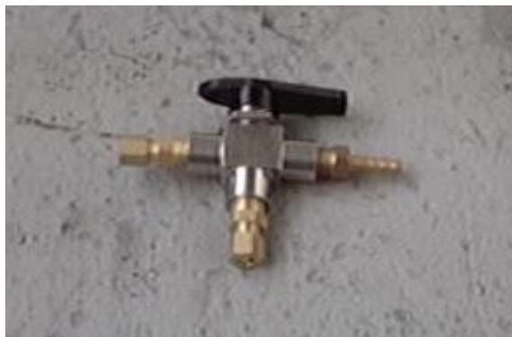
**Figura 1.8.- Válvula de Tres vías**
