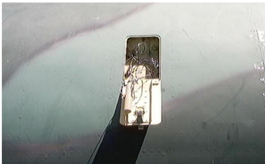
**Figura 1.3.- Dispositivo para Abrir la Canopy**
