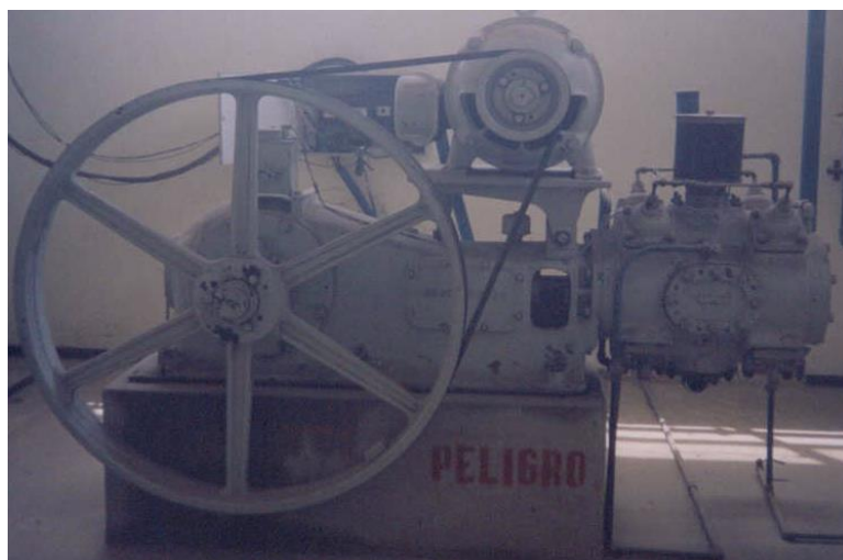
Fotografía No. 1.1 Compresor del sistema neumático
