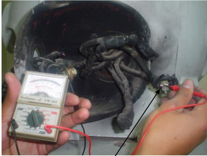
Fotografía No. 3.6 Medición de la continuidad en los bobinados.
