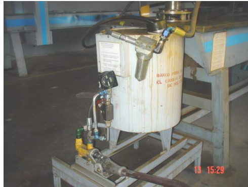
Figura 1.12. Banco de pruebas para evaluar ángulos de hélice del avión TWIN OTHER y fugas
