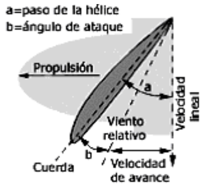
Figura 1.8. Ángulos de la hélice
