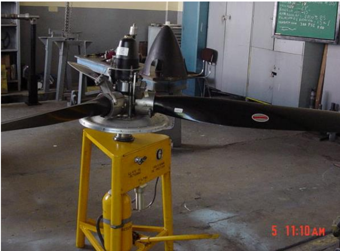
Figura 3.11. Banco para evaluar los ángulos de la hélice HARTZELL
