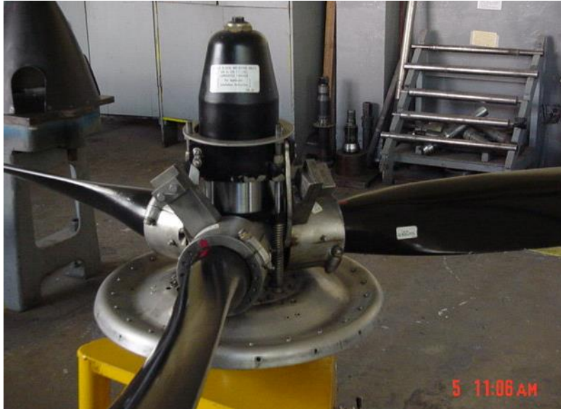
Figura 3.15.b. Hélice en ángulo de 17^\circ o paso alto
