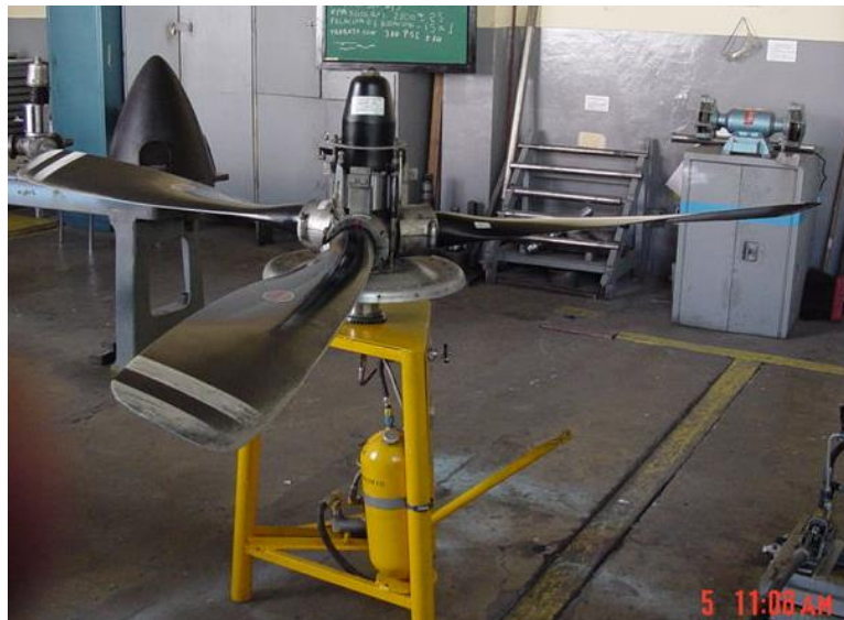
Figura 3.16.a. Hélice en ángulo de -15^\circ o paso de reversa
