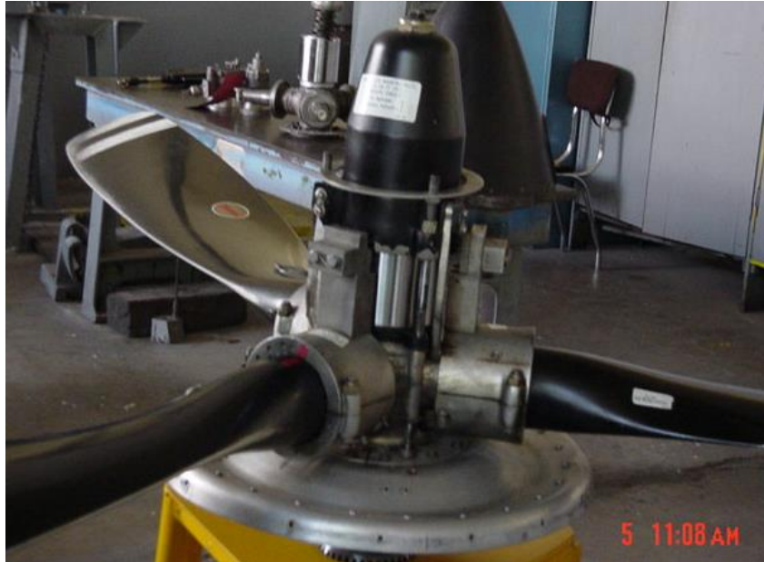
Figura 3.16.b. Hélice en ángulo de -15^\circ o paso de reversa
