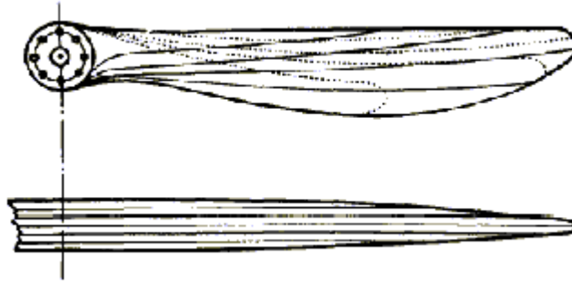
Figura 1.6. Forma aerodinámica de una pala
