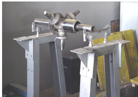
Figura 1.11. Banco de pruebas para inspeccionar el balanceo de las hélices
