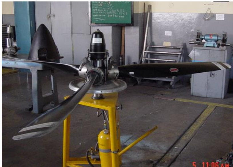
Figura 3.15.a. Hélice en ángulo de 17^\circ o paso alto
