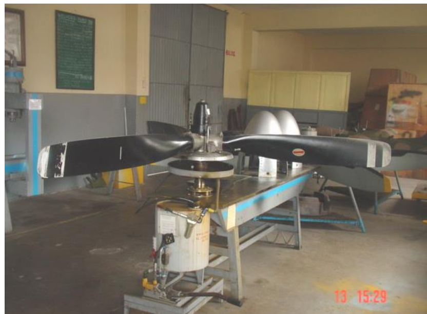
Figura 2.2 Banco de pruebas para evaluar ángulos de la hélice TWIN OTHER
