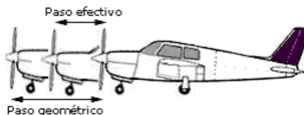
Figura 1.7. Paso efectivo y paso geométrico.
