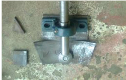
Figura 3. 29: ubicación de las partes para ensamblaje de la muela
