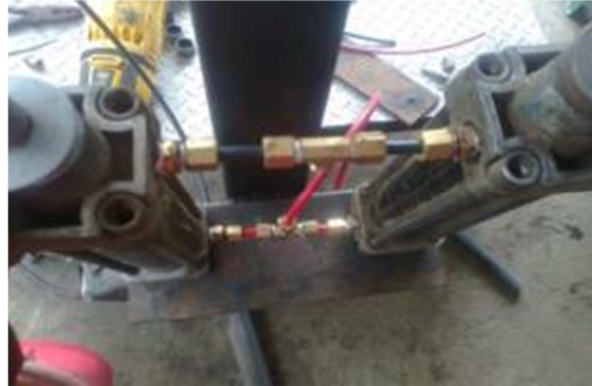
Figura 3. 37: instalación de mangueras neumáticas
