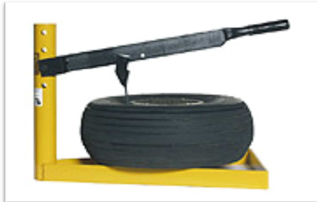
Figura 2. 16: Bead Breaker en funcionamiento
