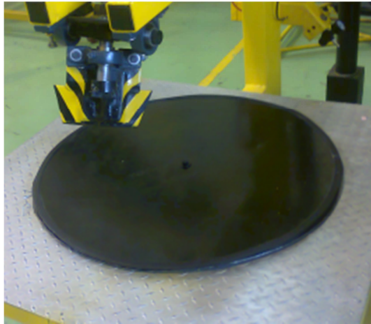
Figura 3. 48: plataforma giratoria instalada
