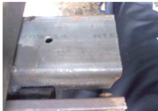
Figura 3. 12: medición de la base estructural tubo de 75 x75 mm y 3 mm de espesor
