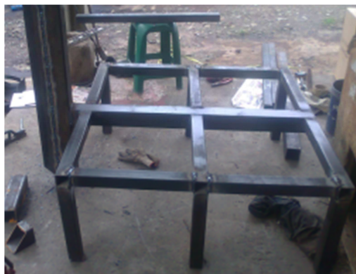
Figura 3. 19: viga principal unida a la base
