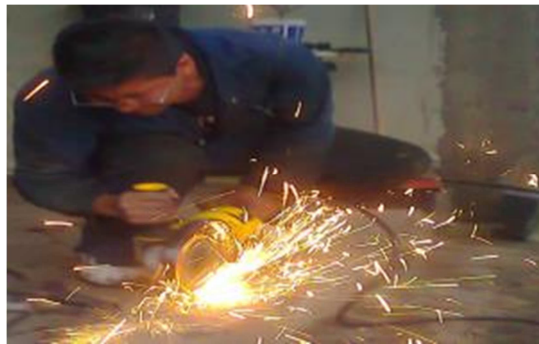
Figura 3. 14: corte del tubo cuadrado de 50 x 50 mm y 3 mm de espesor
