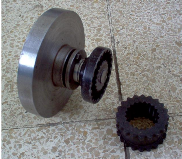
Figura 2.11: Matrimonio o acople del banco al motor
