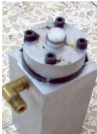
Figura 2.8: Cilindro actuador de funcionamiento hidráulico
