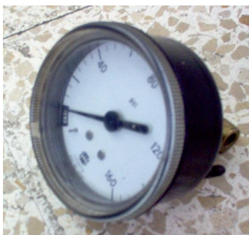
Figura 2.10: Indicador de presión hidráulica
