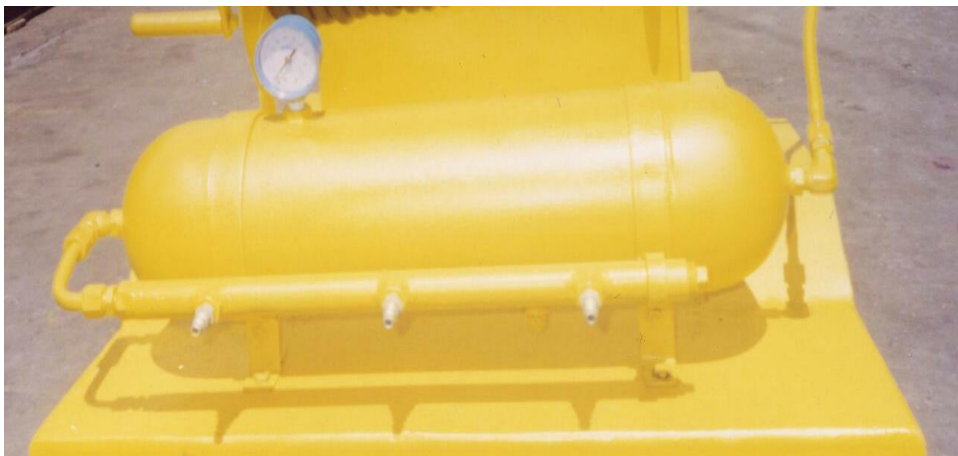
Fotografía 3.6 Distribuidor de Aire Comprimido con sus Accesorios
