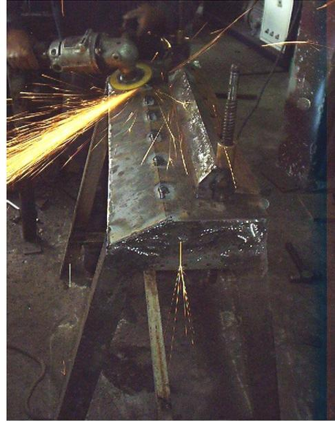
**B8. Pulido y colocación de tornillos**
