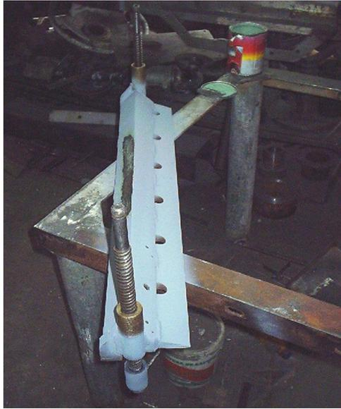
**Fig. 3.5 Cuchilla Sujetadora.**
