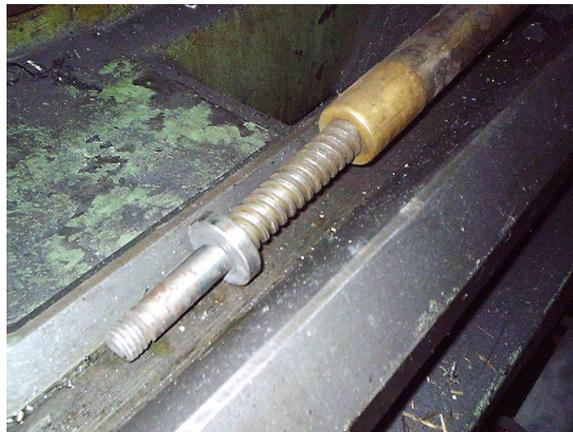
**Fig. 3.8 Tornillo de potencia**
