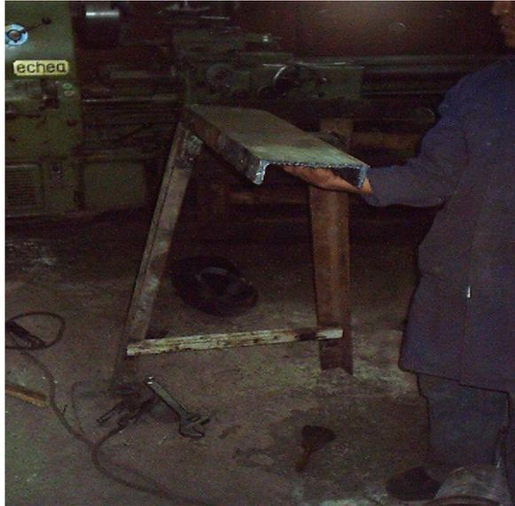
**Fig.3.4 Base y soporte de la dobladora**
