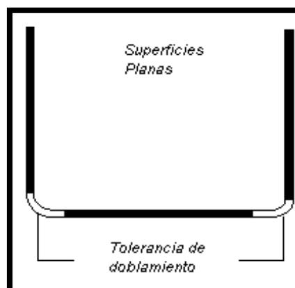
**Fig. 1.8a. Trazado Plano de una Pieza Acanalada**
