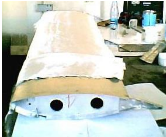
Fig. (a) Rayado y cortado de la tela de vidrio para la fabricación del revestimiento por medio de molde
