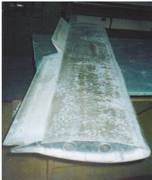
Fig. 2.2. Maqueta construida en fibra de vidrio.
