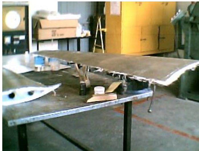
Fig. (b) Construcción del revestimiento aplicando fibras de vidrio y resinas
