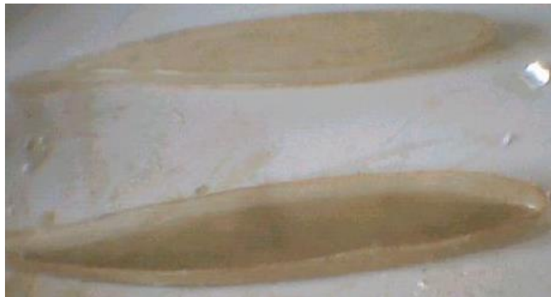
Figura 3.6. Costilla terminada en material compuesto
