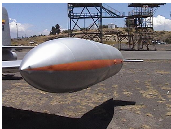
Figura 3.11 Franjas en los tanques de combustible
