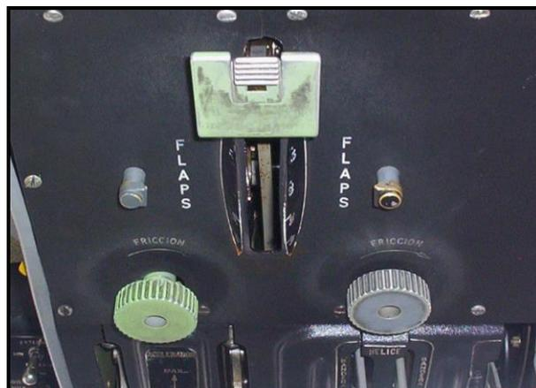
Fig. 2.18: Palanca selectora de flaps
