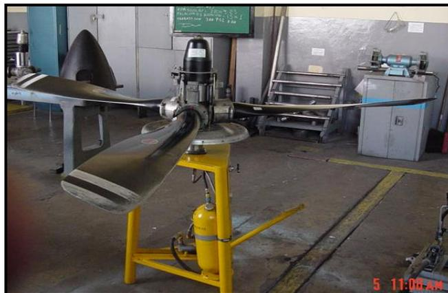
Fig. 2.20: Banco evaluador de ángulos de la hélice Hartzell
