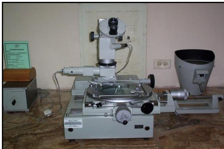
Fig. 2.7: Microscopio de utillaje
