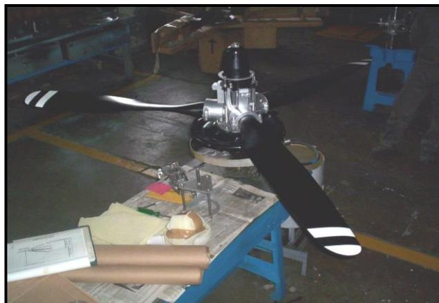
Fig. 2.15: Paso de reversa o -15°
