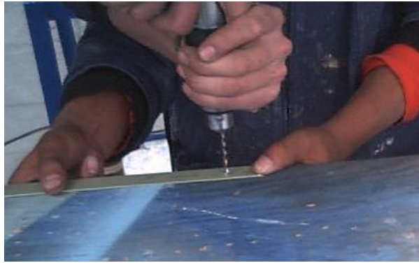
Figura 3.18 Orificos en el stiffener
