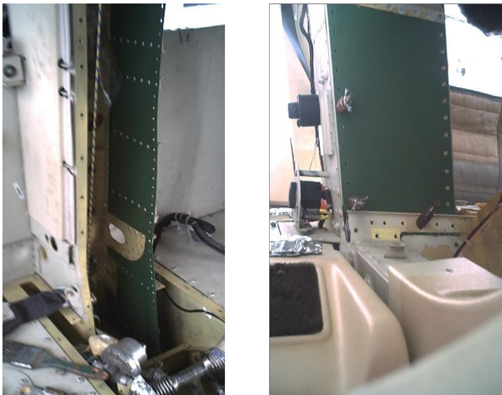
Figura 3.23 Stiffener y panel sujetos con clecos
