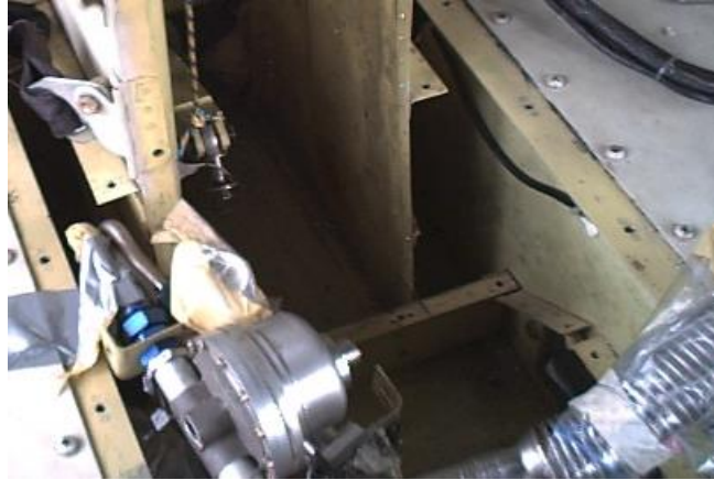
Figura 3.4 Cañerías alojadas en la parte del túnel
