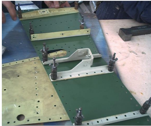
Figura 3.20 Instalación de las partes reusables
