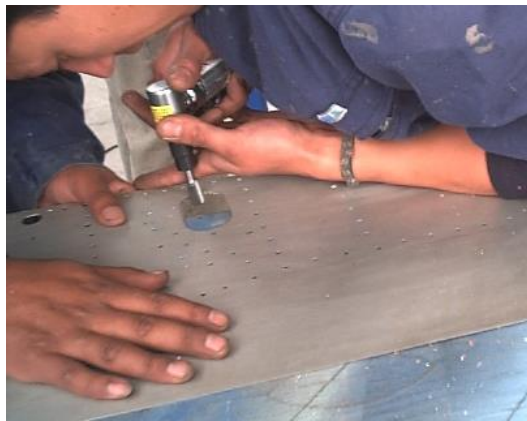
Figura 3.11 Perforaciones en la lámina
