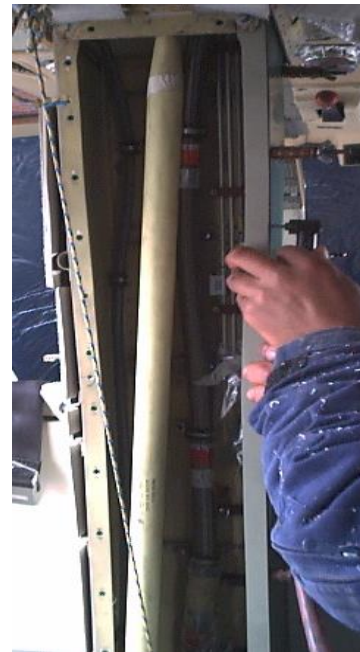
Figura 3.19 Pase de agujeros del panel al stiffener
