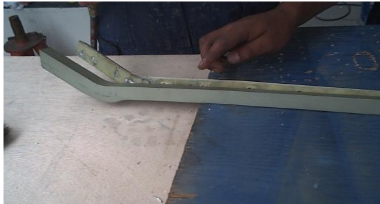
Figura 3.15 Stiffener nuevo y Stiffener obsoleto
