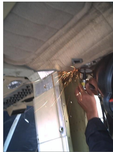
Figura 3.5 Retiro de remaches
