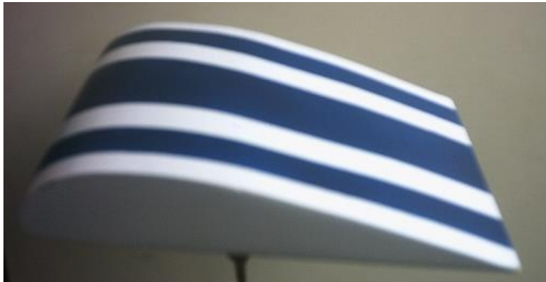
Fig. 3.8 Sección aerodinámica asimétrica (vista lateral)
