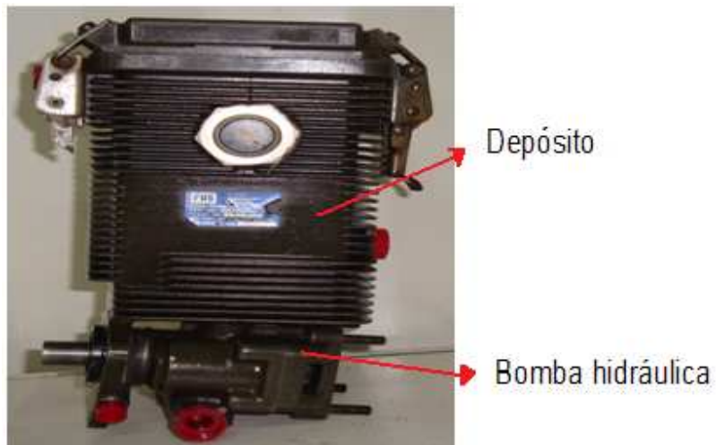
Figura.2.4 Depósito y bomba hidráulica.
