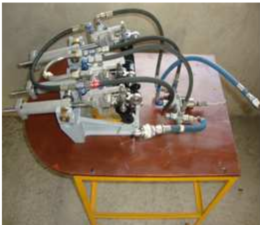
Figura # 7 Conexiones de cañerías e instalación del filtro
