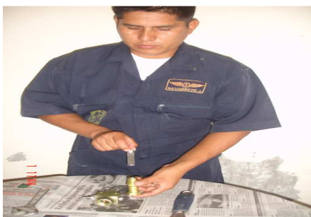
Figura. 14 Desarmado del filtro hidráulico
