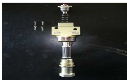
Figura. 14 Desarmado del filtro hidráulico
