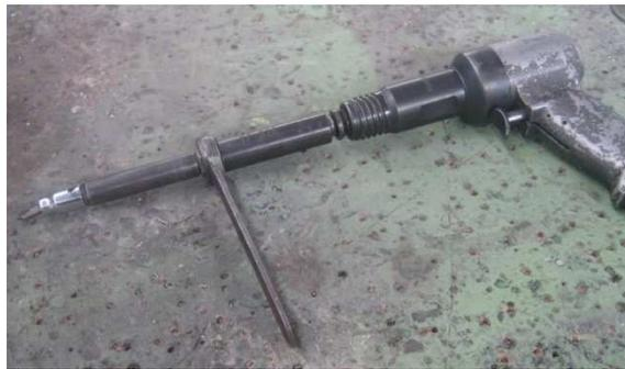
Figura. 2.24 Extractor de tornillo adaptable al martillo neumático
