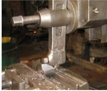
Figura.3.33 Desbaste tipo escalón del buje
