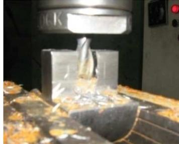
Figura.3.20 Desbaste del buje tipo ranura
