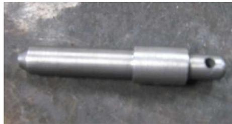
Figura.3.46 Pasador de tornillo de fijación.
