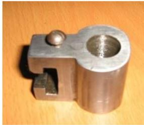
Figura.3.37 Buje del tornillo extractor
