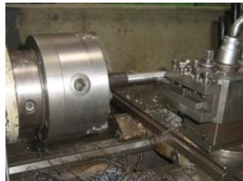
Figura.3.26 Proceso de roscado externo
