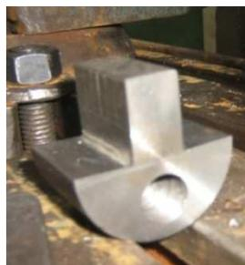
Figura.3.19 Buje desbastado tipo escalón
