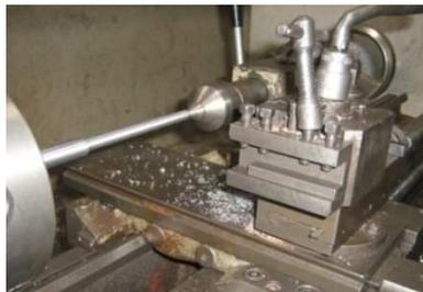
Figura.3.12 Proceso de rectificación de la varilla
