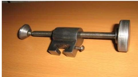
Figura.3.23 Tornillo compensador de momento
