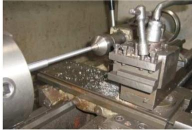
Figura.3.25 Proceso de rectificación de la varilla
