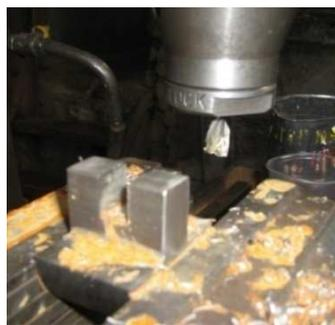
Figura.3.35 Proceso de desbaste del buje
