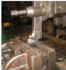
Figura.3.18 Proceso de desbaste tipo escalón
