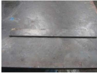
Figura.3.9 Platina de acero 705 PL (38x12x250) mm
