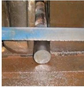
Figura.3.17 Proceso de corte del acero 705
