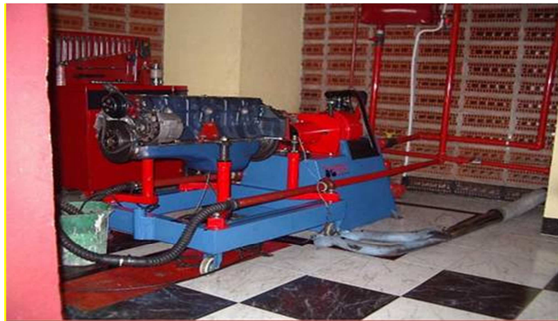
Figura 2.1 Banco de pruebas para un motor de combustión interna.
