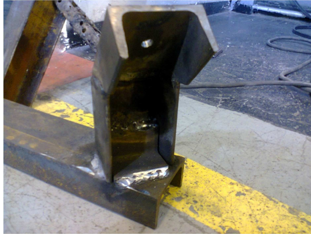
Figura 3.12 Sujeción de los soportes directos del motor.
