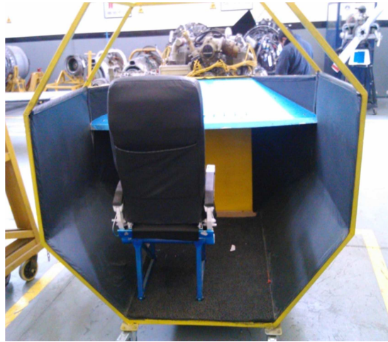
Figura 3.27 Implementación de la alfombra y recubrimiento de las paredes dentro de la cabina de operación.
