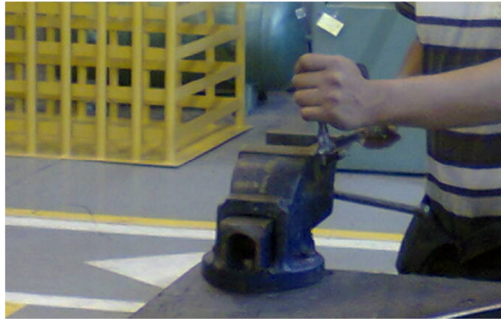
Figura 3.10 Corte de tubos para el banco de puesta en marcha.
