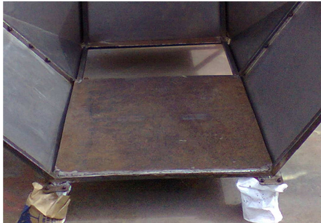
Figura 3.20 Montaje del piso de la cabina de operación.
