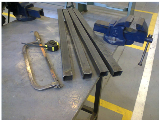
Figura 3.9 Preparación tubos para el banco de puesta en marcha.
