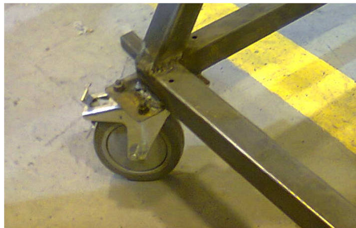
Figura 3.13 Montaje de las ruedas para el banco de puesta en marcha.
