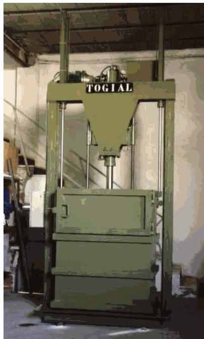
**Figura 1.7 Prensas hidráulicas verticales**
