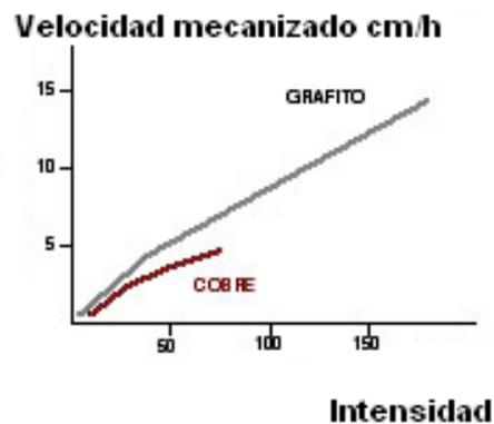
**Figura1.10. A) Variación de la velocidad de mecanizado en función de la intensidad de corriente**
