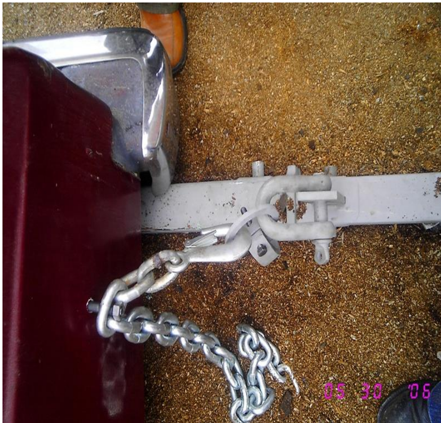
Figura.3.13. Anclaje del vehículo.
