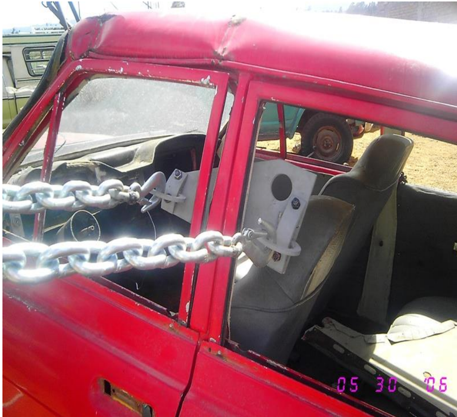
Figura.3.18. Enderezado del parante del automóvil.
