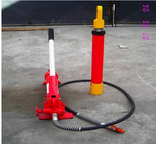
Figura.3.2. Esquema del sistema hidráulico seleccionado.
