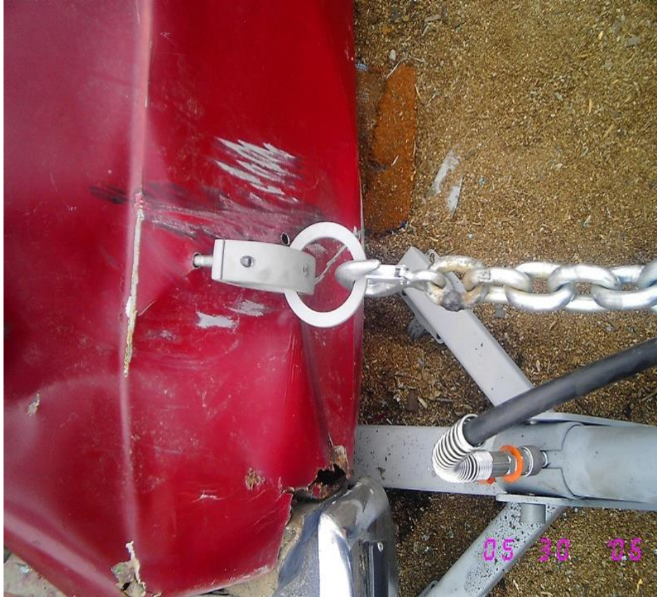
Figura.3.15. Enderezado de la estructura.
