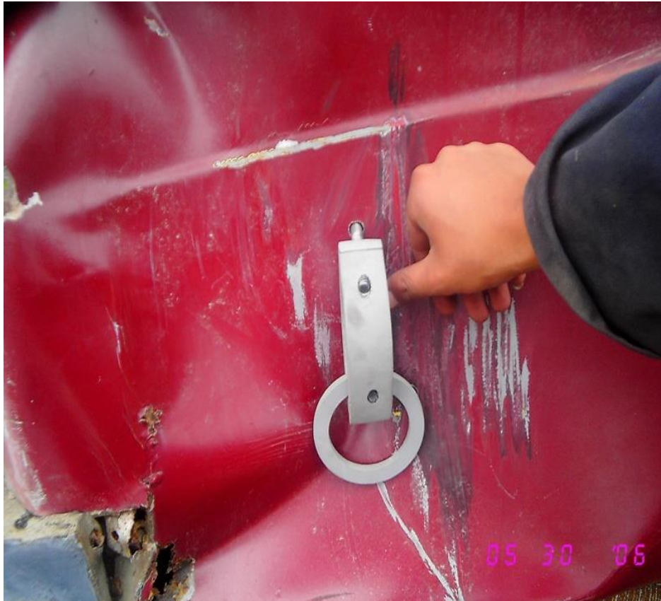
Figura.3.12. Técnica de enderezado.
