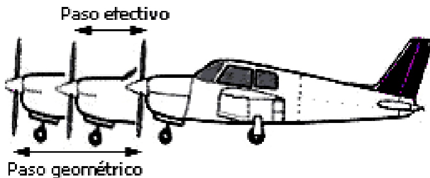
Figura 2.11 Paso efectivo y paso geométrico.
