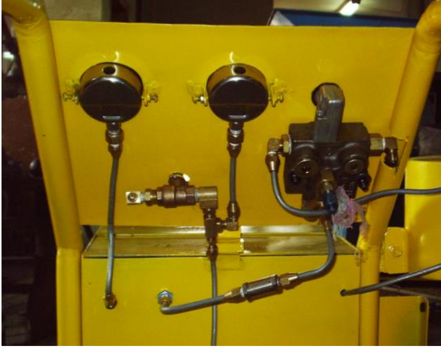
Fig. A.5 Válvula selectora 4 vías, 2 posiciones acoplada a la válvula check.
