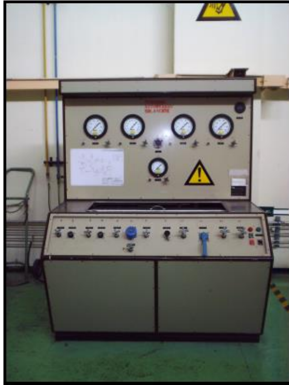
Figura 2.1 Banco de prueba hidráulico estático para acumuladores (P/N EH03 – A).
