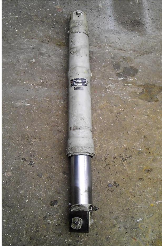
Fig. 1.17. Shock absorber del avión Arava.
