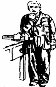
Fig. 3.2 Altura correcta del tornillo
