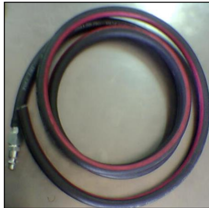
Figura 3.6. Cañería de Aire.
