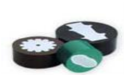
Fig. 2.5 Probetas montadas en resinas termoendurecibles
