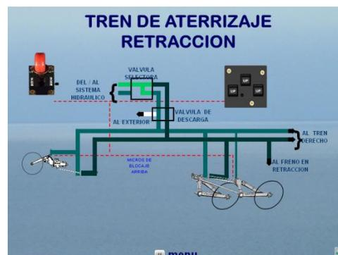
Figura 3-38 Sistema de retracción del tren
