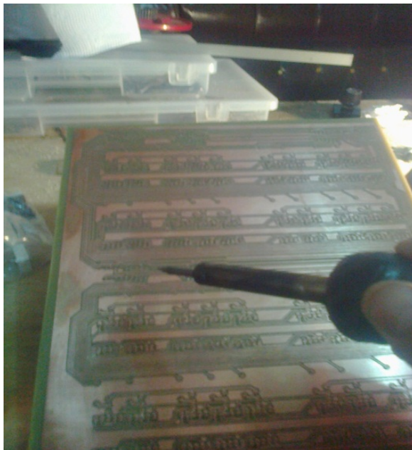
Figura 3.23 Soldado de componentes a la placa de baquelita
