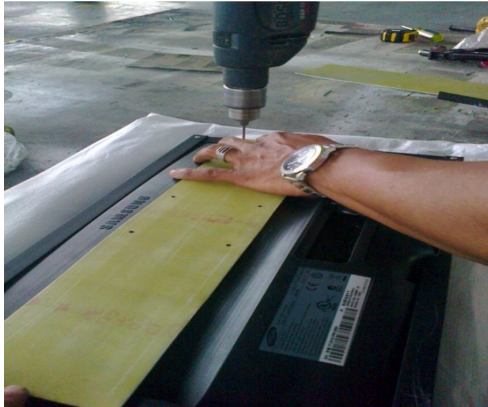
Figura 3.13 Construcción de soporte de pantallas
