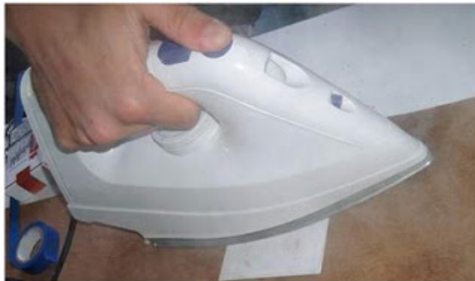
Figura 3.19 Planchado de circuito en placa de baquelita.
