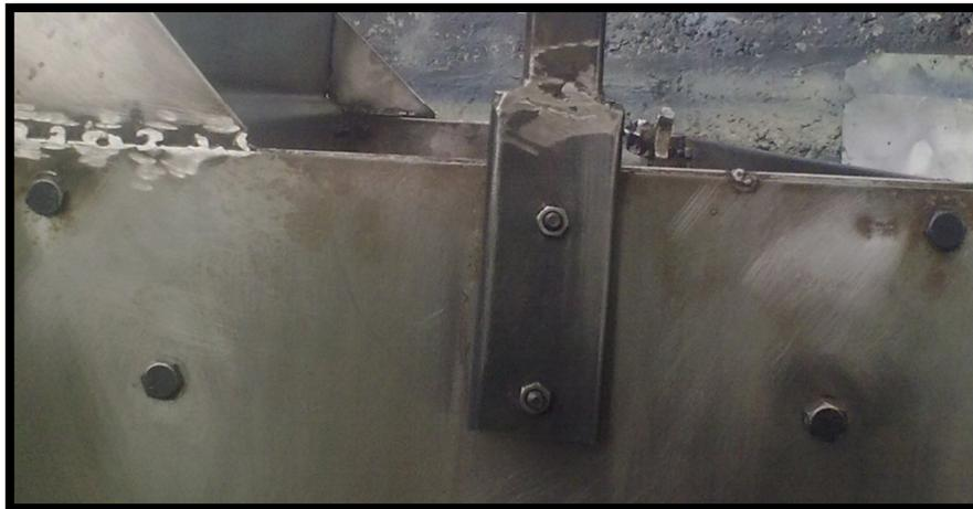
**Figura. 3.2** Pernos de sujeción del banco de magnetización
