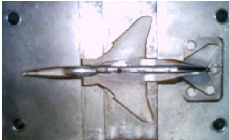
Fig. N° 3.15. Parte erosionada de la parte superior del avión.
