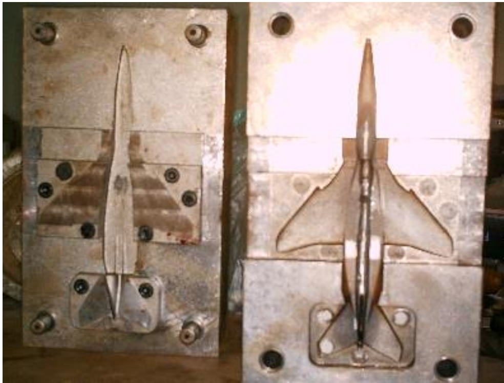
Fig. Nº 3.18 Molde terminado y después de las pruebas.
