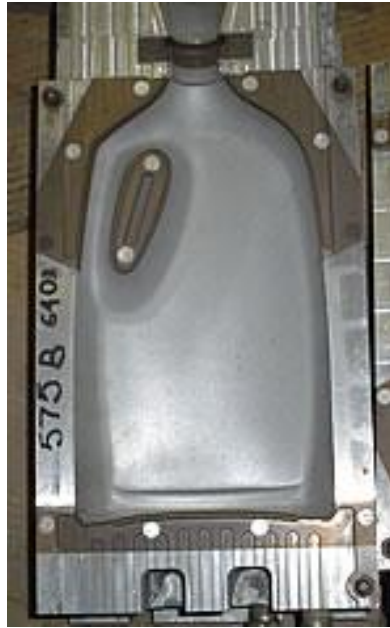
Fig.: 1.9. Molde de acero para soplado de una galonera plástica de 64 onzas.
