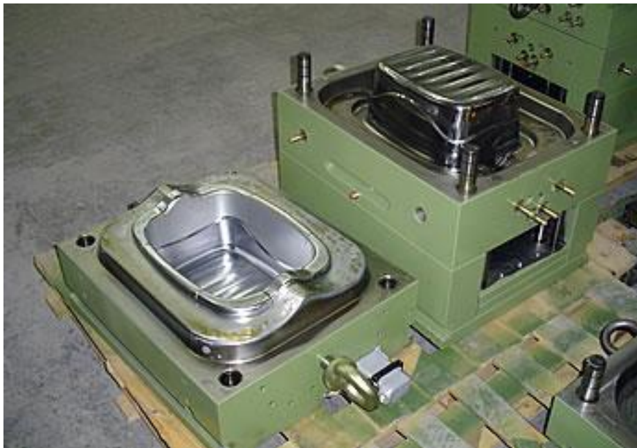
Fig.: 1.15. Molde de acero para la inyección de una tina plástica.
