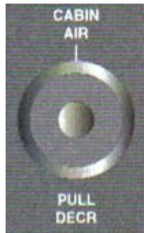
**Figura 2.15. Palanca de control de aire caliente a la cabina**
