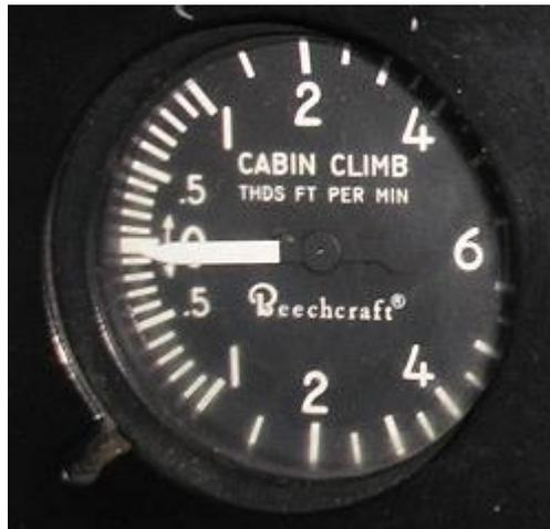
**Figura 2.20. Indicador de velocidad vertical**
