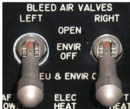
**Figura 2.16. Conmutador de las Bleed Air Valves**
