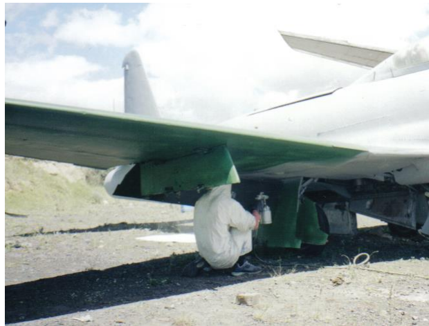
Fig.3.7 Aplicación del Primer
