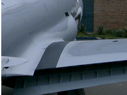
Fig.3.14 Camino de Seguridad
