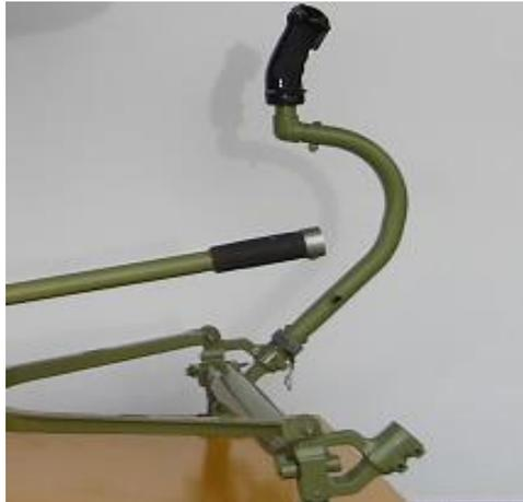
**Figura. 10. sistema de control de vuelo**
