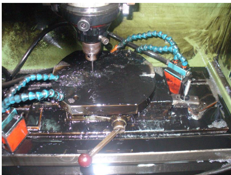
Fig. 3.6 Drenaje del diesel (líquido dieléctico)
