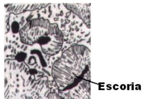
Fig. 1.21 Inclusiones de escorias
