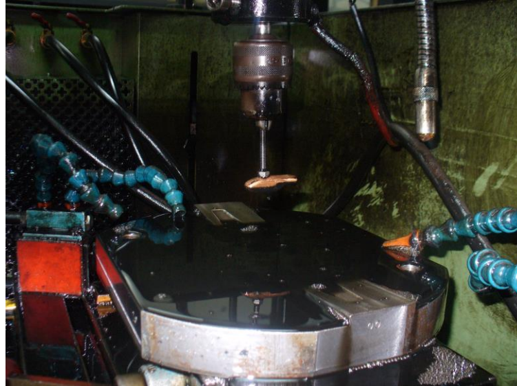
Fig. 3.7 Desbaste de la barquilla
