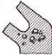
Fig. 1.23 Burbujas en la estructura de la fundición
