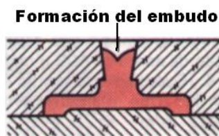
Fig. 1.19 Contracción de solidificación
