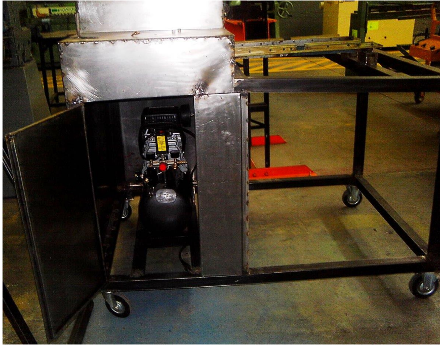
C.3.- Banco de pruebas con la puerta de acceso abierta
