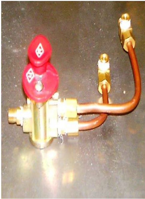
A.5.- Distribuidor de aire hacia los polivalentes
