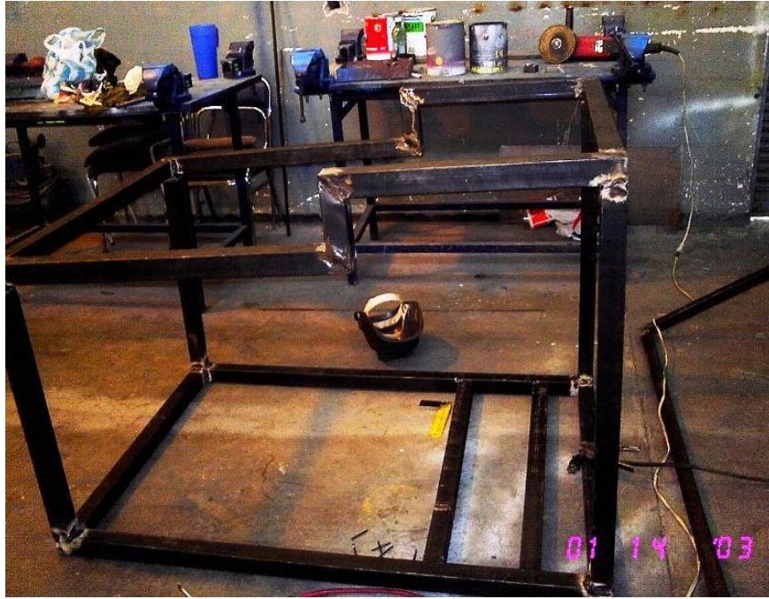
B.3.- Estructura principal armada
