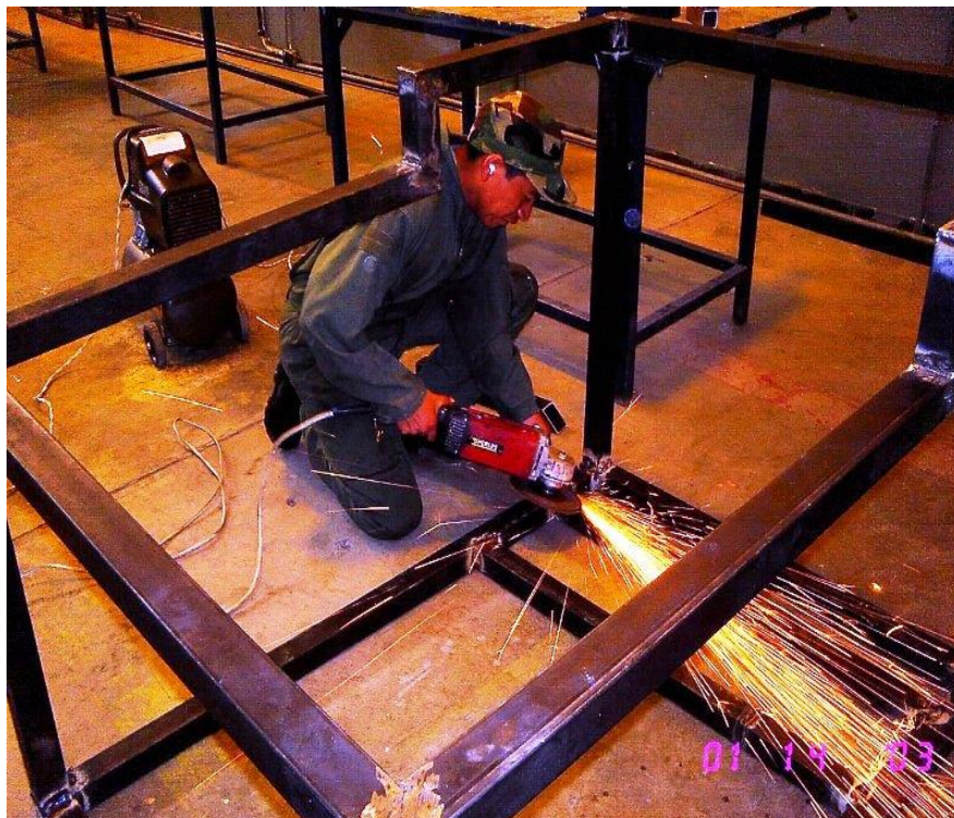
B.2.- Proceso de pulido de las uniones soldadas
