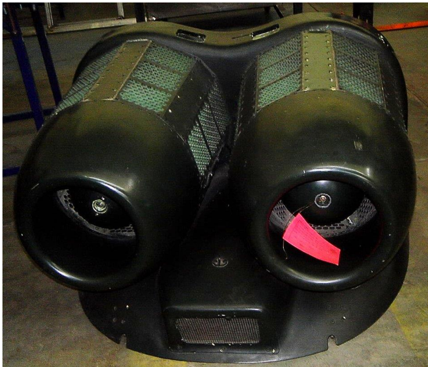
A.7.- Consola de los filtros antiarena
