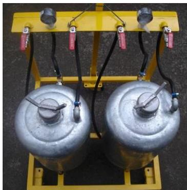
**Figura № 5.26:** Ensamblaje del equipo de lavado de compresores.
