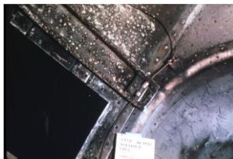
**Figura N° 2.3:** Corrosión por Picadora.
