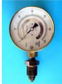
**Figura N° 5.6:** Manómetro de Burdon.
