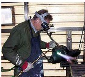
**Figura N° 5.4:** Soldadura oxiacetilénica.
