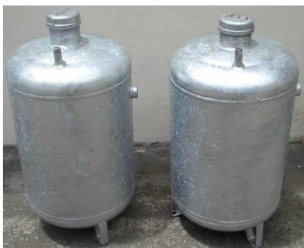
**Figura № 5.23:** Galvanizado de los reservorios cilíndricos.
