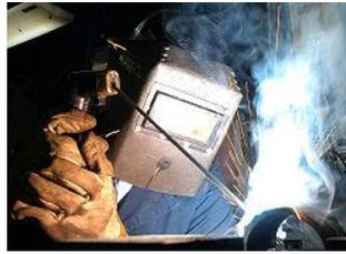
**Figura N° 5.2:** Soldadura de arco
